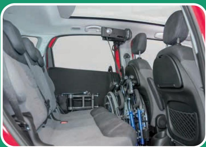
partie arrière. Dans ce cas, il est donc nécessaire d'installer la porte escamotable. Le treuil est disponible en deux versions: la version de base où la montée et la descente du fauteuil roulant sont pilotées par un interrupteur, et la version "deluxe" où le mouvement est piloté par une boîte à boutons qui, éventuellement, contrôle aussi l'ouverture et la fermeture de la porte électrique. Construit avec des matériaux solides et résistants, il peut charger jusqu'à un poids maximal de 25 kg.
